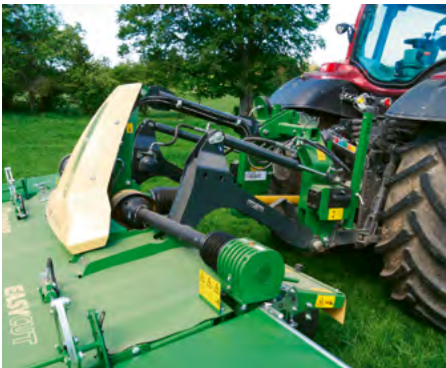
Le cadre d'attelage est poussé et s'accouple directement aux bras inférieurs. Le délestage est hydraulique.
