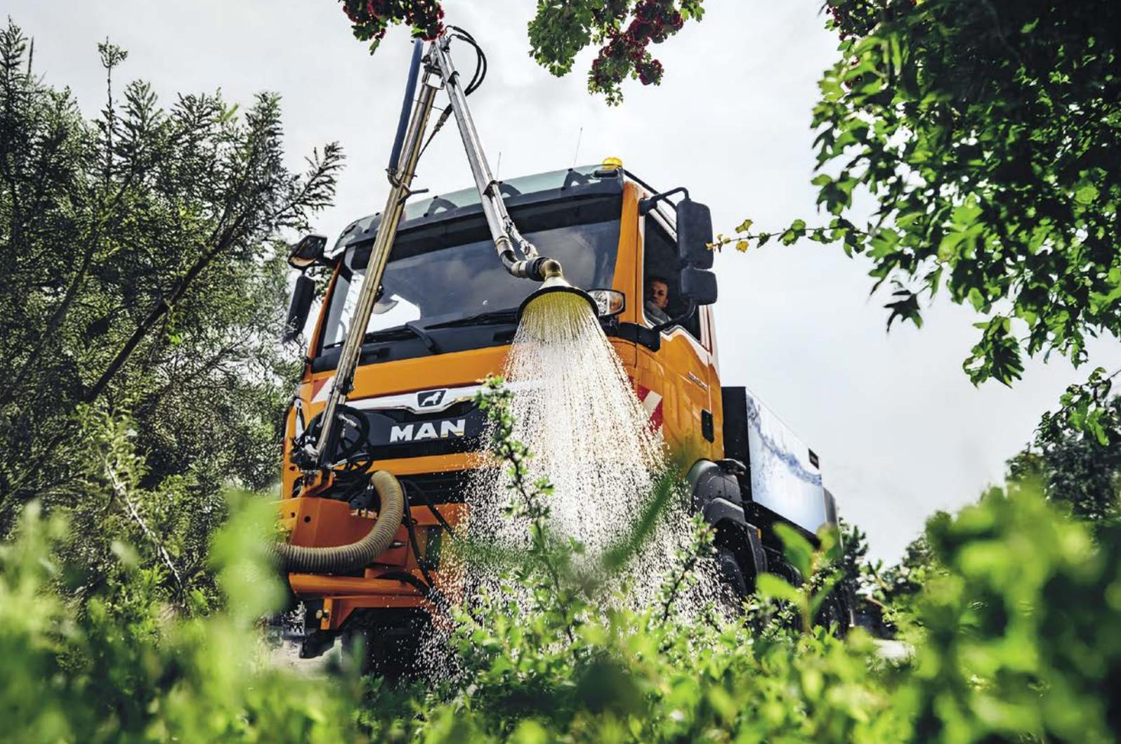
Bewässerungssysteme mit Giessarmen sind im Aufwind: Die FAXx-Serie von Kugelmann vereint Wassertank, Giessanlage und Solestreuer in einem System und ist in Grössen von 250 bis 10000 Litern erhältlich. (Fotos: zVg.)
