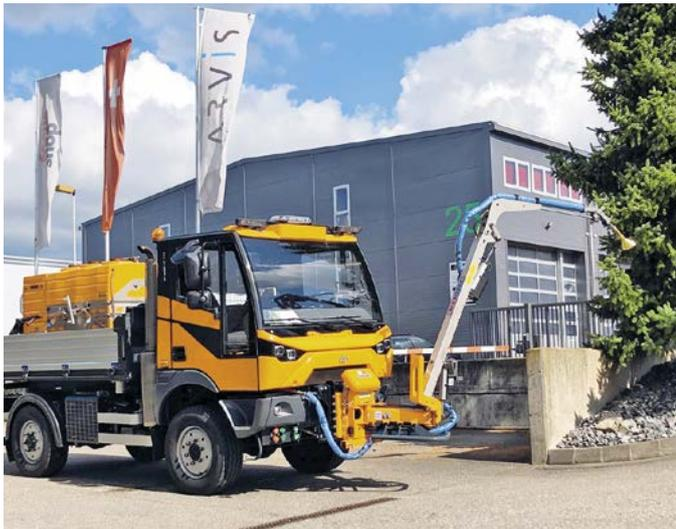
Der 12V-Elektroantrieb mit CAN-BUS-Technologie der Fiedler-Giessarme ermöglicht eine präzise und gleichzeitige Bedienung aller Bewegungen.
