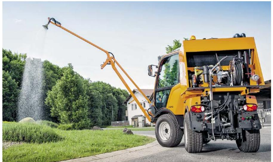
Der Eco-MultiWash Wassertank ermöglicht im Niederdruckbereich schonendes Giessen mit dem Giessarm oder mit der abnehmbaren Handlanze mit Giessbrause.
