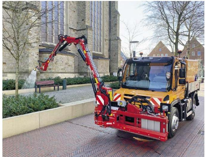
Dücker-Auslegerarme mit Schnellwechselsystem ermöglichen den zügigen Austausch von Schlegelmähköpfen, Astscheren und Giessköpfen. (Fotos: zVg.)
