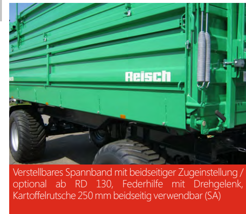
Spannkette m. beidseit. Bedienungshebel zum abklap. der Bordwände bei gespannter Kette, Funktion - Hebel unten - Bordwand auspendeln (S-RD 130) Umlaufende Abdichtung mit Profilgummi (S-RD-150)
