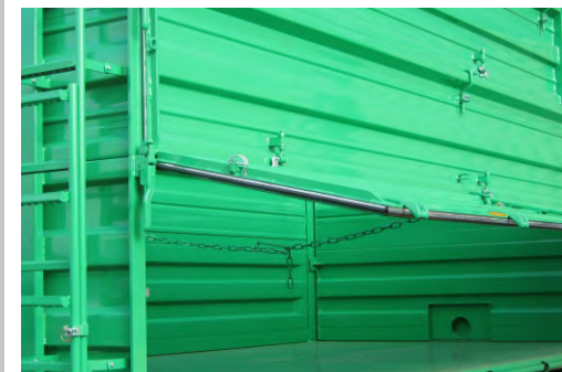
Spannkette m. beidseit. Bedienungshebel zum abklap. der Bordwände bei gespannter Kette, Funktion - Hebel unten - Bordwand auspendeln (S-RD 130) Umlaufende Abdichtung mit Profilgummi (S-RD-150)
