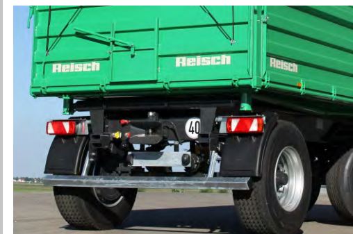
Automatische Anhängerkupplung mit langen Hebel, Brems- u. Hydraulikanschluss für 2. Anhänger, geschraubter u. verzinkter Unterfahrschutz, ECOPOINT II - Fünfkammerbeleuchtung (S)
