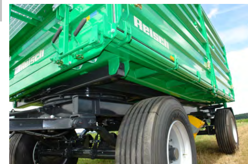
Überdimensionierter Drehkranz mit 8 Schmierstellen in gedichteter Ausführung, 27 to. Zugdeichsel, 2 Blatt-Parabelfederung, Bordwandverriegelung 8-fach (S), geteilte Zentralverriegelung, Mittelrunge (SA)
