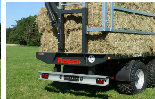
Geprüfter ALU – Unterfahrerschutz mit integrierter 5 Kammer-Beleuchtung und Umrissleuchten, Kotflügel auf der Hinterachse (S)
