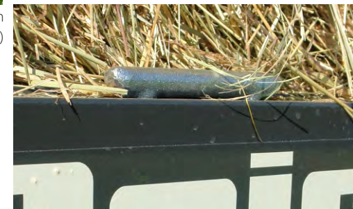
7 – 10 Paar versenkte Zurrösen mit 2to Lastaufnahme je nach Fahrzeugtyp (S)
