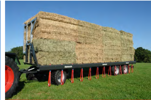
Optimale Beladung mit Ballen, da Ladegatter im abgeklappten Zustand unter dem Plateau positioniert ist.
