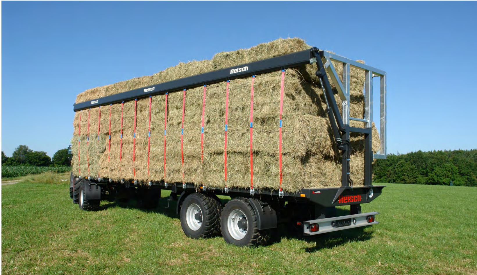
Optimale Beladung mit Ballen, da Ladegatter im abgeklappten Zustand unter dem Plateau positioniert ist.
