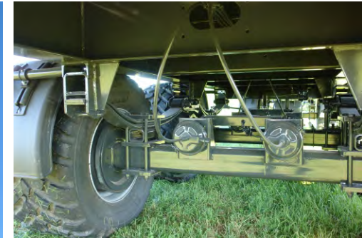
Verstärkte 2 Blatt Parbelfederung mit 1 bzw. 2 ALB Reglern, Verstärkte Rahmenkonstruktion mit Querversteifungen (S)
