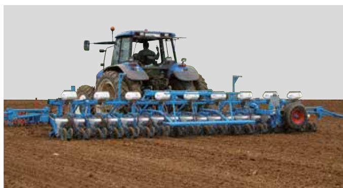
Starre 18-reihige MECA V4-Einzelkornsämaschine mit Dreifach-Rahmen und Langfahrvorrichtung
