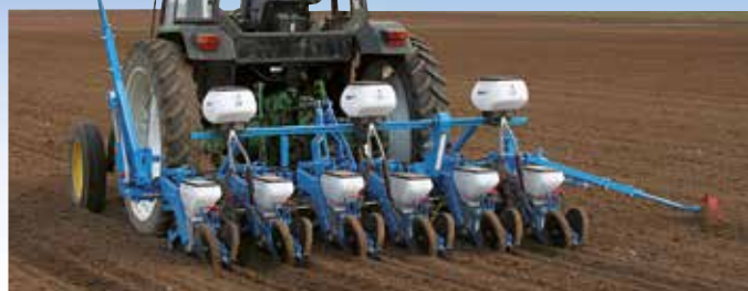
Starre 6-reihige MECA V4-Einzelkornsämaschine mit einfachem Rahmen und Microsem
