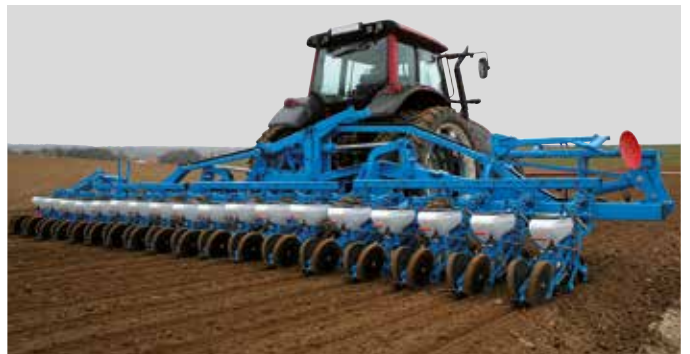
18-reihige dreistufige klappbare MECA V4-Einzelkornsämaschine
