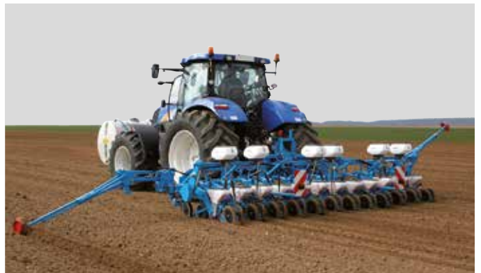
12-reihige klappbare MECA V4-Einzelkornsämaschine mit Doppelbalken und Microsem
