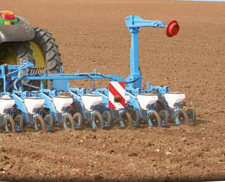
12-reihige kompaktklappbare MECA V4-Einzelkornsämaschine mit Microsem
