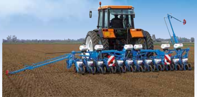
12-reihige kompaktklappbare MECA V4-Einzelkornsämaschine mit Microsem
