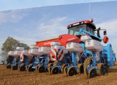
Pneumatische Einzelkornsämaschine Typ Monoshox NG Plus M mit Doppelscheiben
