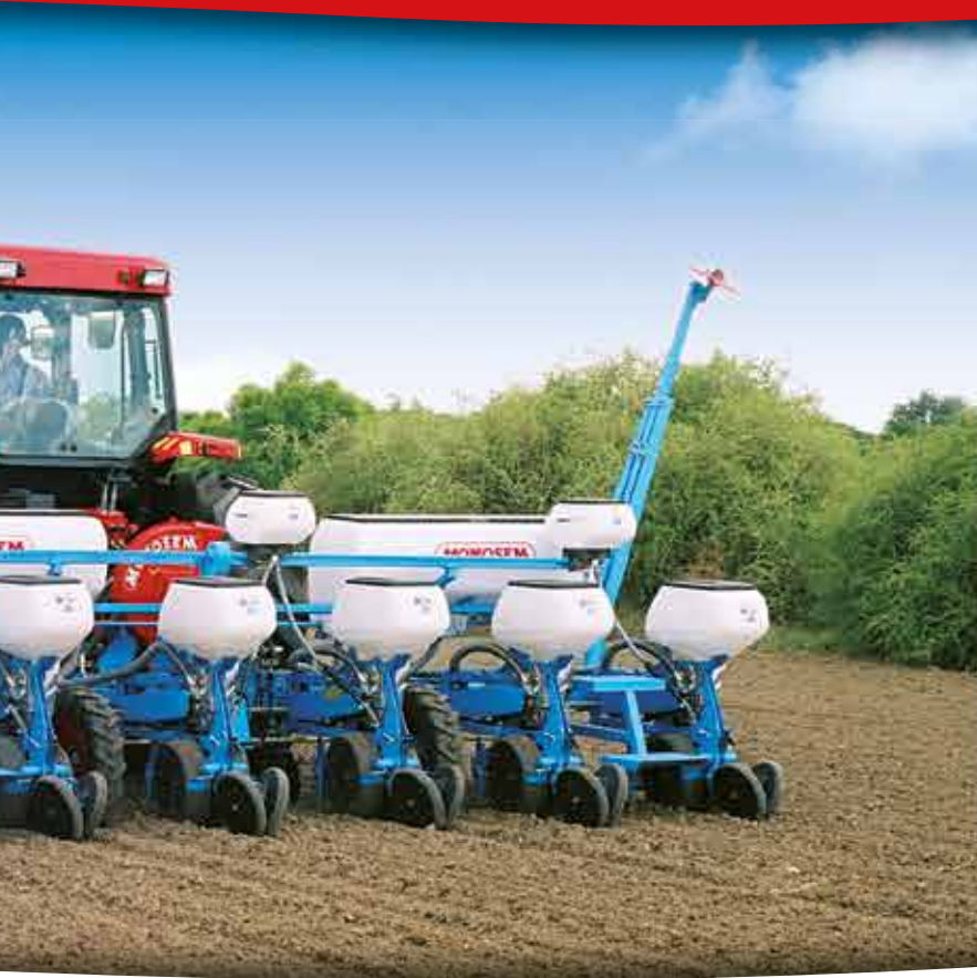
Starre 4-reihige, Monobar-Sämaschine (75 cm Reihenabstand).
