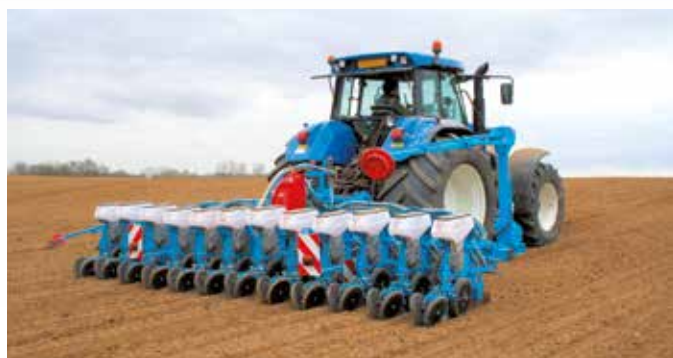
12-reihige, klappbare Doppelbalken-Sämaschine (45 cm Reihenabstand)
