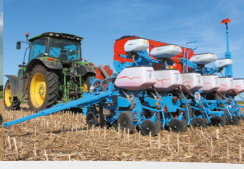
Spezial pneumatische Einzelkornsämaschine Monoshox NX M für « Minimalbodenbearbeitung » mit Doppelscheiben
