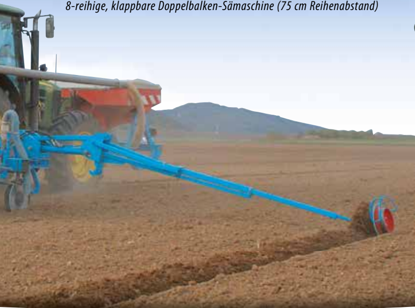
8-reihige, klappbare Doppelbalken-Sämaschine (75 cm Reihenabstand)
