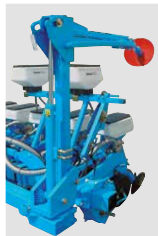
12-reihige, klappbare Doppelbalken-Sämaschine (45 cm Reihenabstand)
