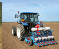
Spezial Gemüsesämaschine Typ MS für Feinsaat
