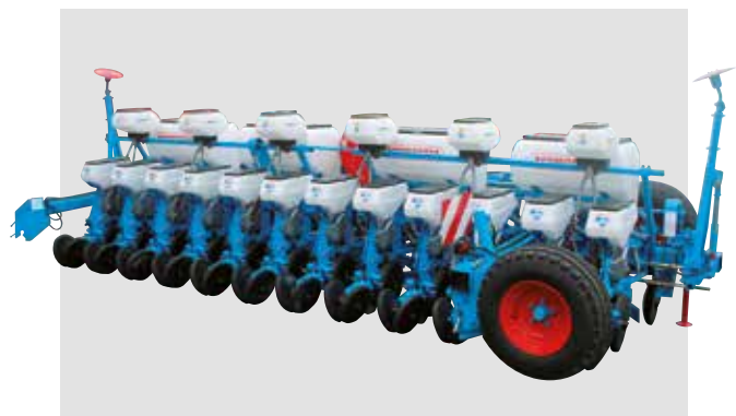
Starre 12-reihige, doppelbalkige Sämaschine (45 cm Reihenabstand) mit Längstransportwagen.
