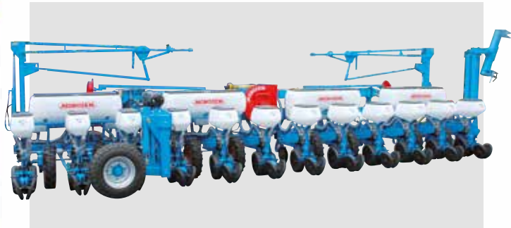
12-reihige, gekuppelte Sämaschine (75 cm Reihenabstand).
