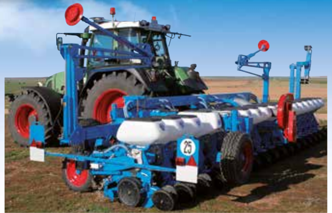
18-reihige, gekuppelte Sämaschine (45 cm Reihenabstand).
