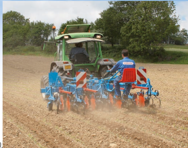
Die über die Lenkstange (2) geführten Leiträder (1), sind in der Höhe einstellbar (3).
