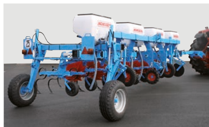
Starres TIP 5" Hackgerät, 8 Reihen mit 70 cm Abstand, in Transportstellung
