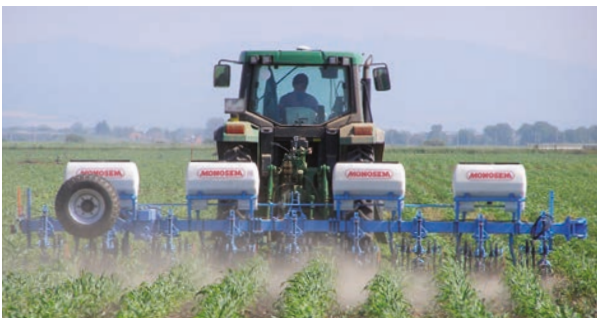
Starres TIP 5" Hackgerät, 8 Reihen mit 70 cm Abstand, im Einsatz
