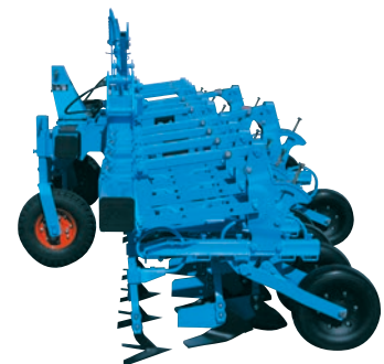
Front-Hackmaschine «umgedrehte Hackelemente» 12 Reihen mit 45 cm Reihenabstand
