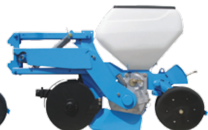
NC-Technic Säelement für Mais mit Hinterradföhrung und mit Doppelscheibenscharen.
