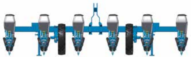
Einfachteleskoprahmen in Arbeitsstellung.
