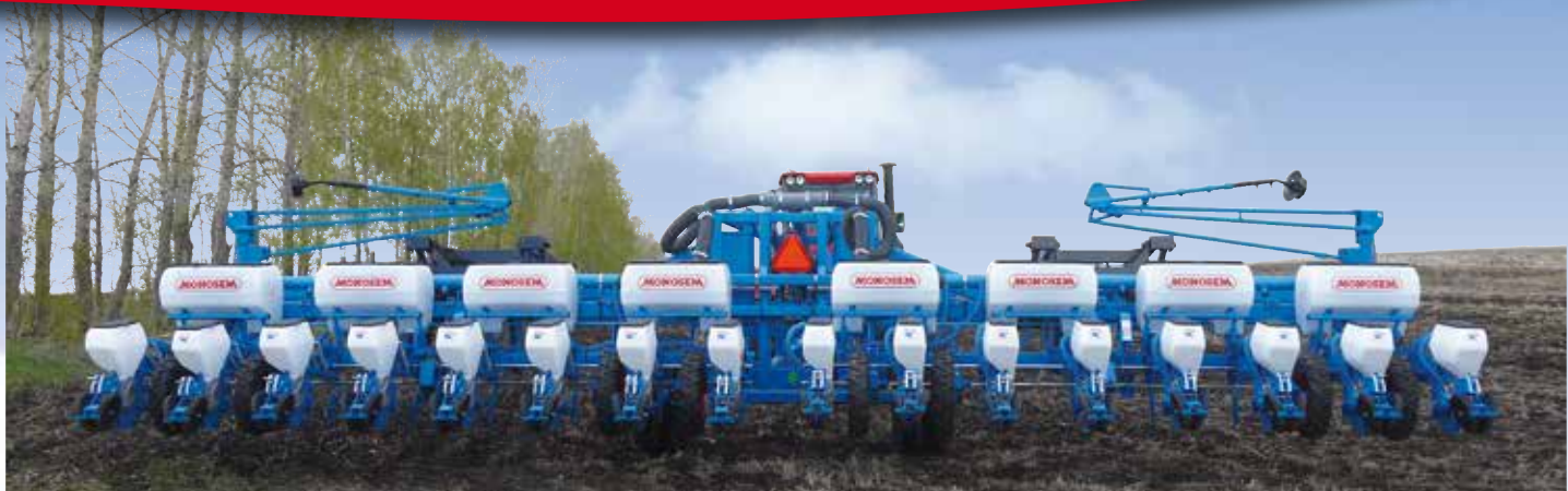
16-reihige NC Technic Mais Sämaschine auf 70 cm Reihenabstand Kombination von 2 starren Doppelrahmen 8 Reihen mit Düngerstreuer 4 x 175L mit Schar auf Couple-Rahmen
