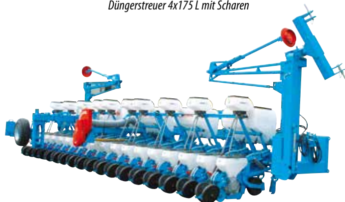
NC Technic Zuckerrüben Sämaschine 18 Reihen Couple Rahmen (45 cm). Microsem und Düngerstreuer 6x175L. mit Scharen. Langfahrvorrichtung.
