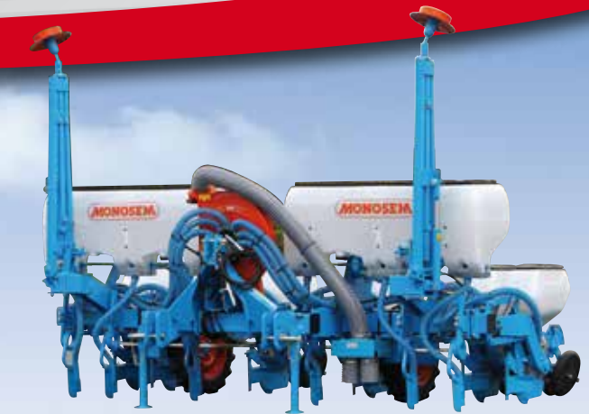
6-reihige - Mais NC Technic Sämaschine Monoblock – Einfachteleskoprahmen (75cm) Düngerstreuer 2x270L mit Schare
