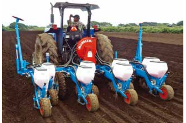
NC Classic V2 Sämaschine - 2 x 4 Reihen Twin-Row starrer Monobar Rahmen (4 Reihen Twin-Row)
