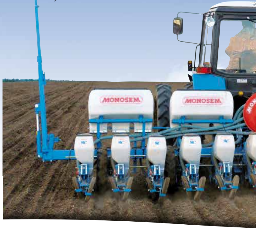
12 Reihige- NC Technic Sämaschine Starr Monobar (45cm) Düngerstreuer 4 x 175L mit Schar
