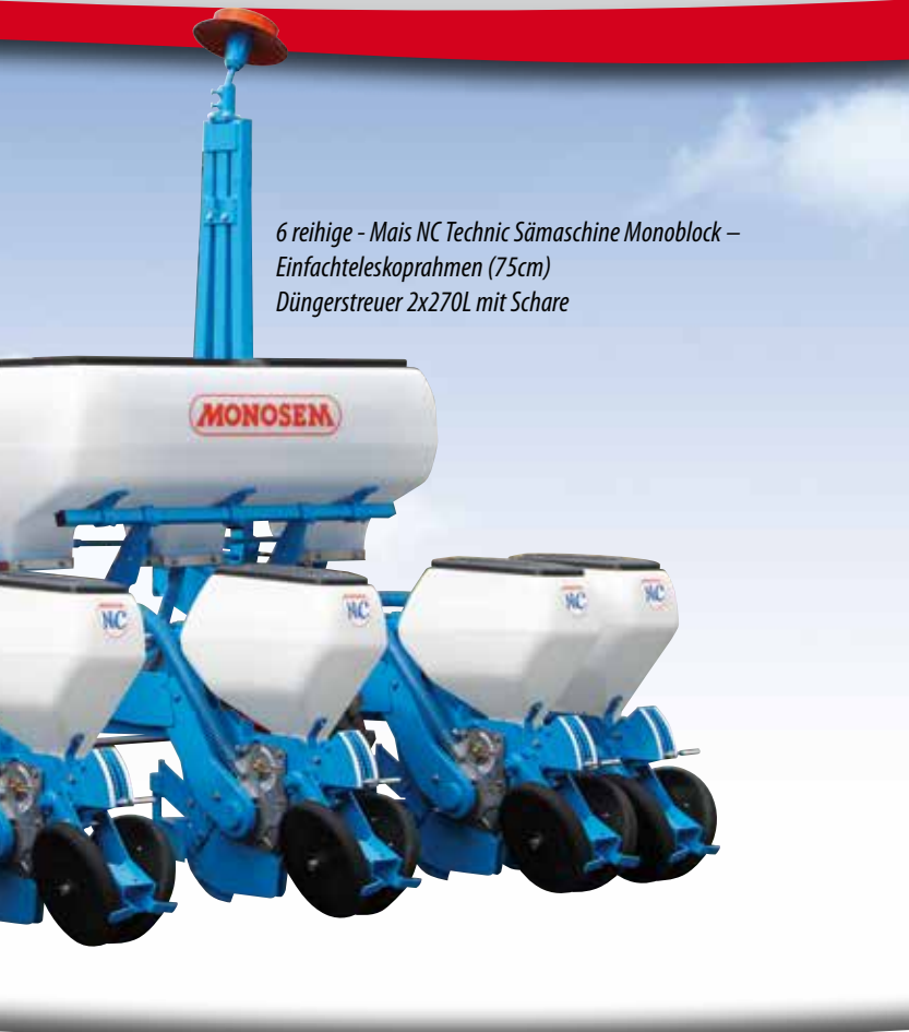
6-reihige - Mais NC Technic Sämaschine Monoblock – Einfachteleskoprahmen (75cm) Düngerstreuer 2x270L mit Schare
