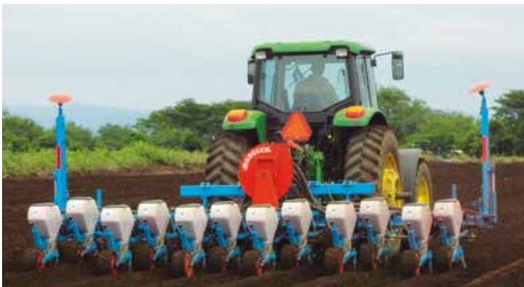
NC Classic V2 Sämaschine - 2 x 6 Reihen Twin-Row starrer Doppelrahmen (6 Reihen Twin-Row)
