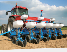
Pneumatische vielseitige Einzelkornsämaschine Typ NG Plus 4 mit Doppelscheiben
