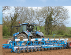
Mechanische Einzelkornsämaschine Typ MECA V4 für Zuckerrüben
