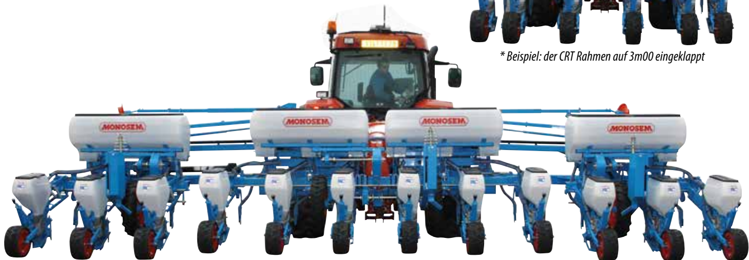
12 Reihige- NC Classic V2 Sämaschine - auf 75 cm CRT Rahmen klappbar auf 3m00*
