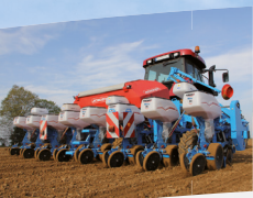
Pneumatische Einzelkornsämaschine Typ Monoshox NG Plus M mit Doppelscheiben
