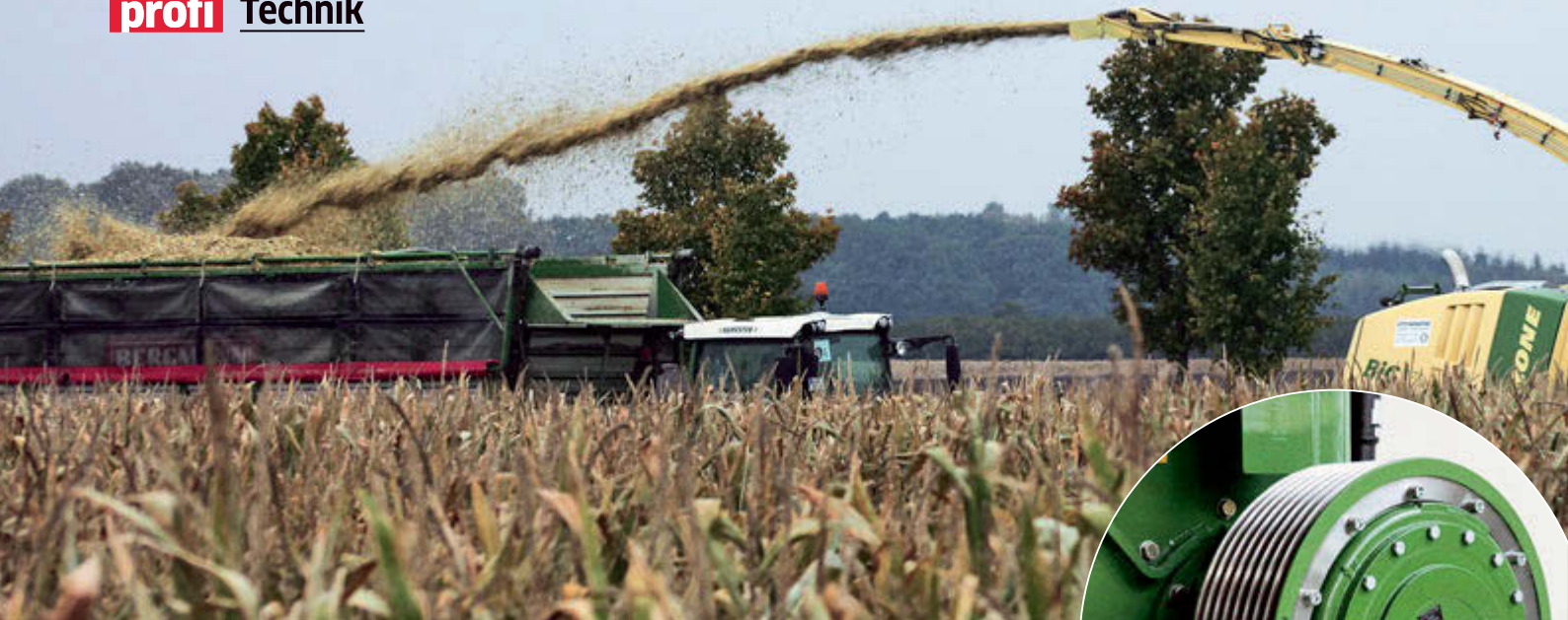
Für den BiG X 600 bis 1100 hat Krone mit dem VariLOC jetzt ein Trommelgetriebe im Programm.
