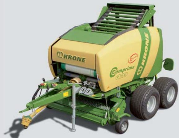
Der Vorteil der semivariable Ballenkammer gegenüber klassischen Festkammersystemen ist der auch bei großem Ballendurchmesser immer sehr kleine weichere Kern. Dadurch sind die Ballen sehr dicht, formstabiler und deutlich schwerer.
