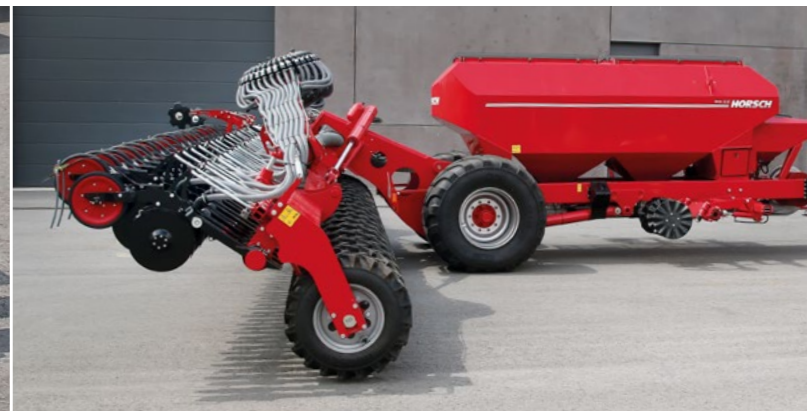
Fahrwerk kommt nur beim Transport zum Einsatz
