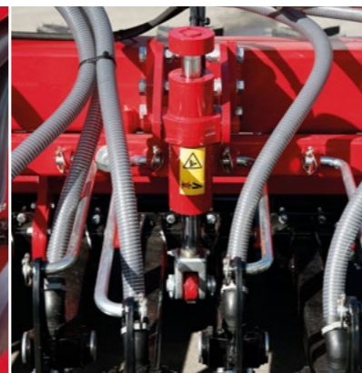
Schardruckeinstellung stufenlos hydraulisch verstellbar
