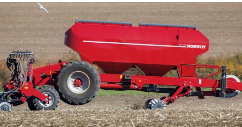
Geteilter Drucktank im Verhältnis 60 : 40 (3 600 l vorne und 2 400 l hinten)
