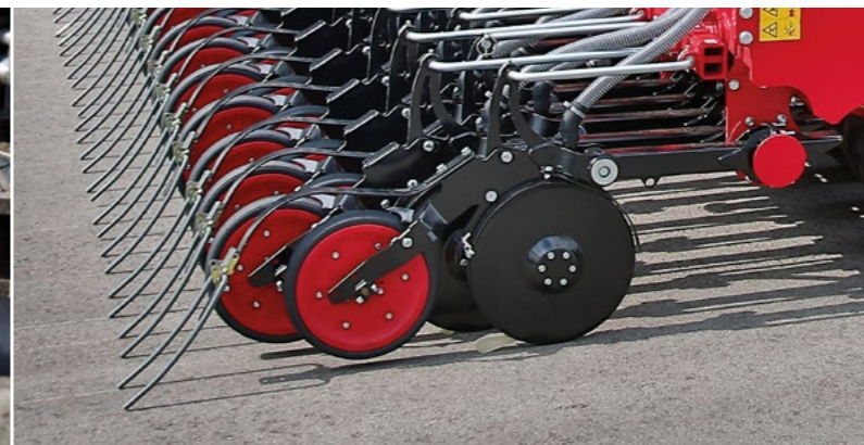
PowerDisc Säschar mit bis zu 150 kg Schardruck
