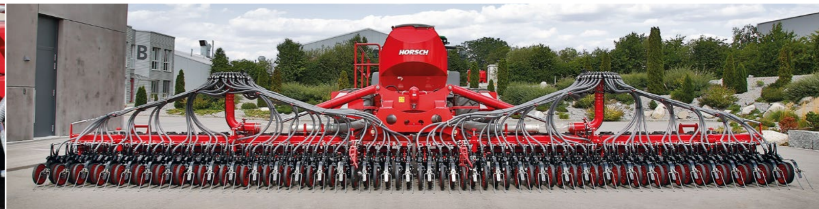
Das komplette Gewicht des Säwagens wird gleichmäßig auf die Flügel verlagert und dient der gleichmäßigen Schardruckerzeugung bis zum äußersten Schar
