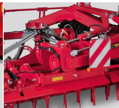
3 Meter Segmente der Kreiselegge sind pendelnd aufgehängt für optimale Boden Anpassung.
