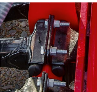
Schwingungsgedämpfte Anhängung Optimale Boden Anpassung und Steinsicherung
