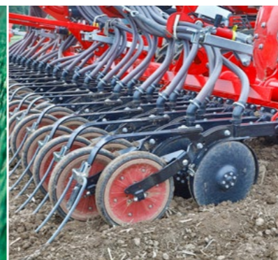
TurboDisc Säschar – Exakte Saatgutablage bei hohen Geschwindigkeiten
