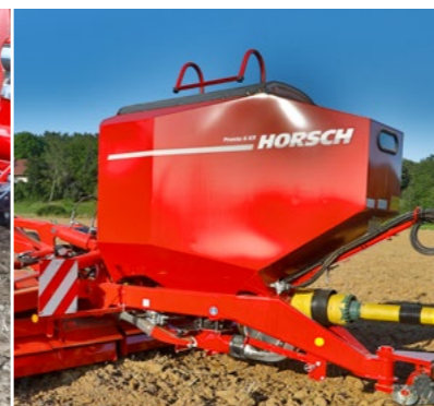
Schlagkraft bei der Saat Der Sätank der Pronto KR fasst 2 800 l.
