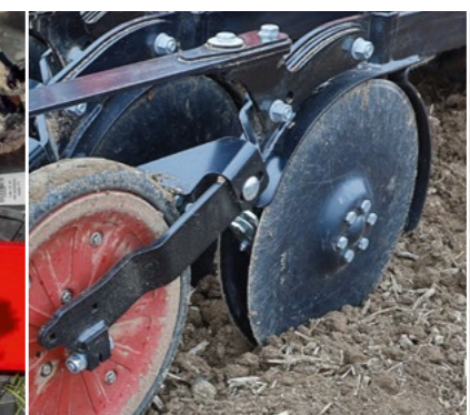
Doppelscheiben-Sächar Gerade Scheibe mit innenliegendem, wartungsfreiem Lager
