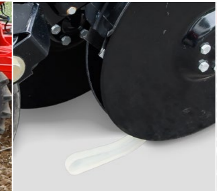
Uniformer und Abstreifer Sichere Saatgutablage in feuchten Bedingungen
