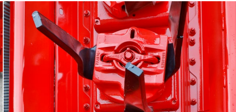
Träger für werkzeuglosen Zinkenwechsel
