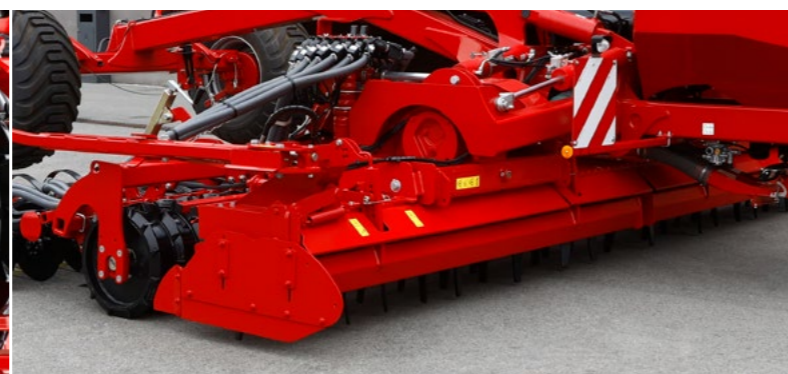
Federbelasteter Seitendeckel für saubere Anschlüsse
