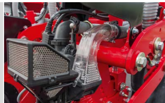
Maestro SW: Dosiereinheit in der Seed On Demand Ausführung
