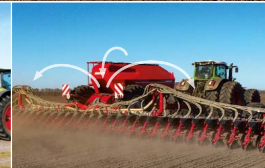
Übertragung des Säwagengewichtes auf die Säschiene für höheren Schardruck
