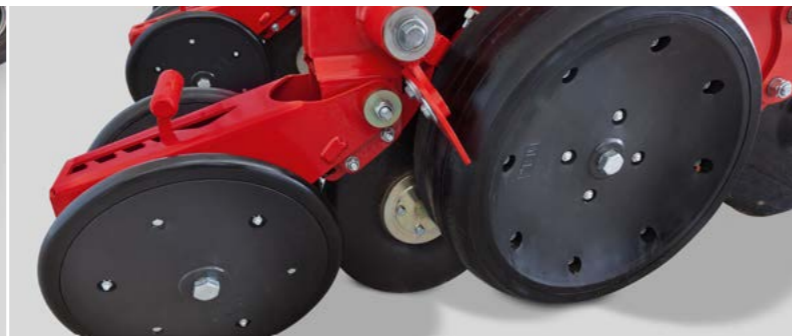
Tiefenführungsrollen mit Abstreifer, verstellbare Andruckrollen und die Fangrolle, die bei sehr feuchten Bedingungen entfernt werden kann, da das Saatkorn nicht mit Druck in den Boden geschossen wird
