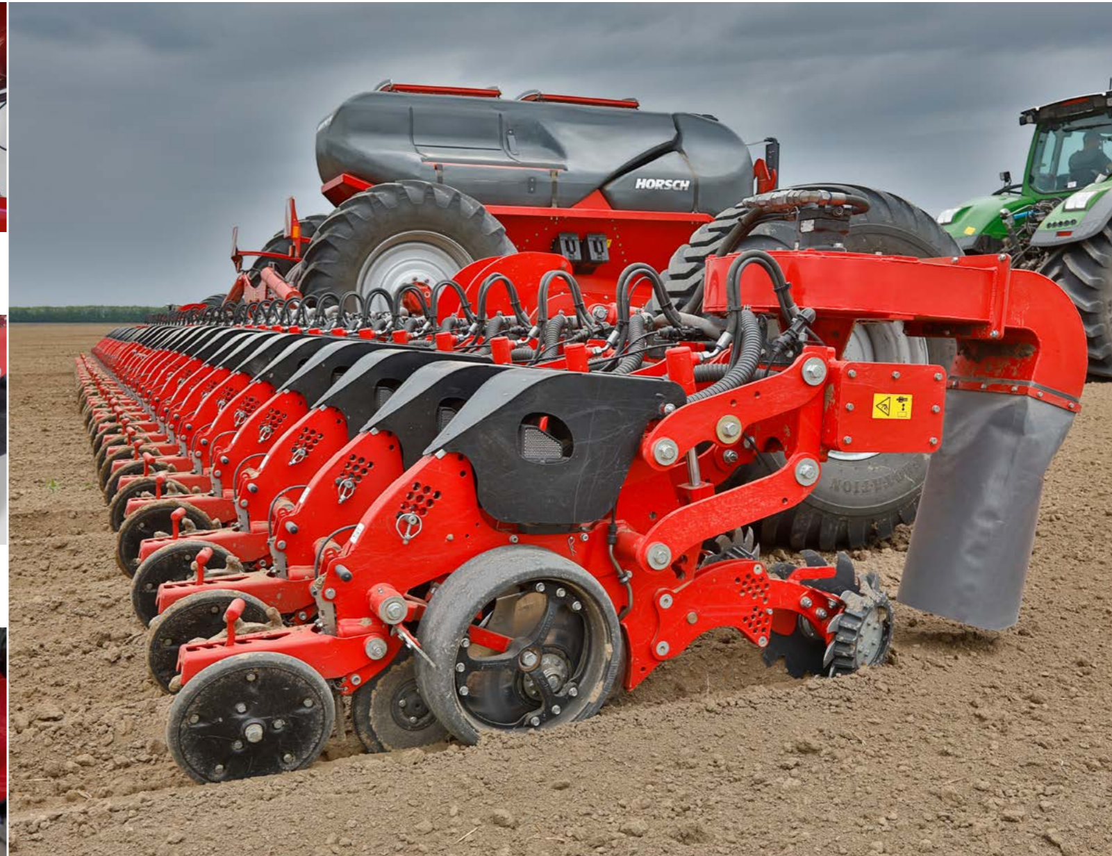
Maestro SW mit Flüssigdüngereinrichtung zur Applikation auf die Saatreihe
