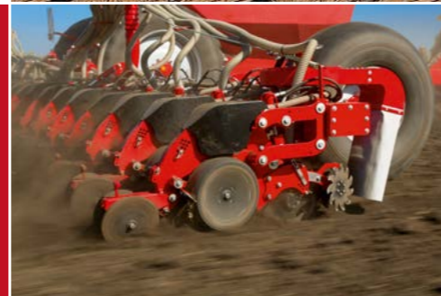
Extrem robuste Einzelkornsäaggregate mit präziser Kornvereinzelnung und Seed On Demand System
