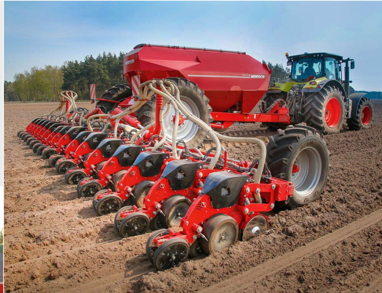
Maestro 16 SW mit breiten Druckrollen
