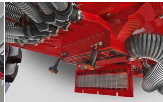
Geöffnetes Seed On Demand System an der Maestro SW
