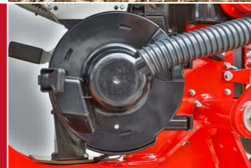
Gut zugänglicher Maestro Einzelkorndosierer
