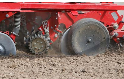
An Flanschplatte befestigte optionale Räumsterne
