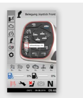
Die Funktion frei belegbarer Tasten auf dem Joystick des ErgoControl kann einfach über das Fahrzeug-Display ausgewählt werden
