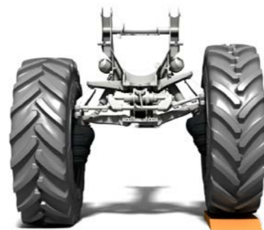
Automatische Niveauregulierung: jedes Rad wird einzeln hydro-pneumatisch gefedert und ausgeglichen.
