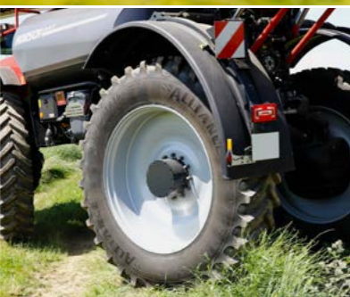
Große Bereifungen mit bis zu 2,18 m Durchmesser
