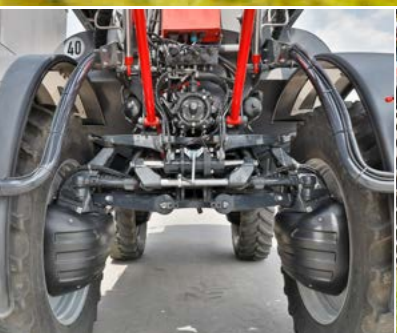
Unterbodenabdeckung und Verkleidungen der Radmotoren schonen den Bestand
