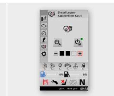
Einstellmöglichkeiten zum Kabinenfilter Kat. IV: Automatik- oder manueller Modus mit Anpassung der Intensität
