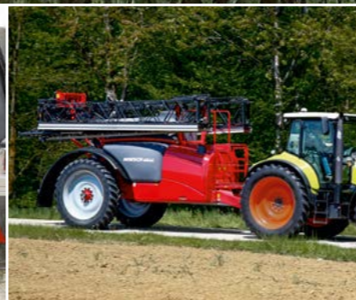
Gestänge ragt nicht nach vorne an die Traktorkabine heran
