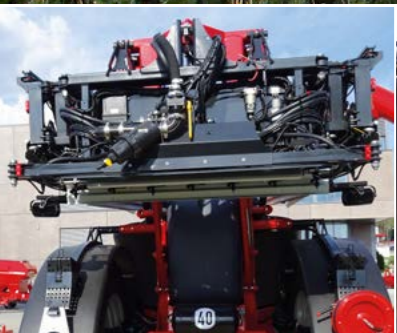
Gestängemittelteil für Arbeitsbreiten 18–30 m, optional mit Pendelrahmen erhältlich.
