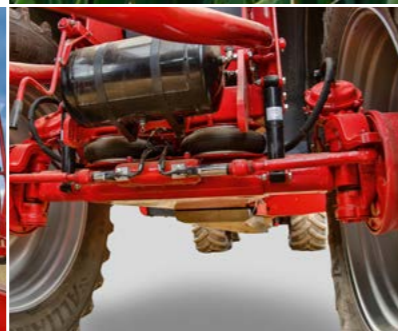
Hohe Bodenfreiheit und glatter Unterboden mit gefederter Achse, optional pneumatisch gefedert
