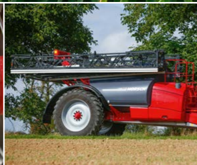
Gestänge ragt nicht nach vorne an die Traktorkabine heran
