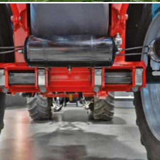
Spurweiten von 1,50 bis 2,25 m (bereifungsabhängig)
