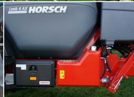
Autarkes Hydrauliksystem auf der AX für geringste Ansprüche an den ziehenden Traktor.
