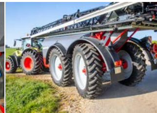
Nachlauflenkung für eine Achse und eine aktive Lenkung für beide Achsen stehen zur Auswahl
