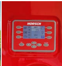
CCS Pro mit komfortablem Außenbedienterminal und automatischen Waschprogrammen
