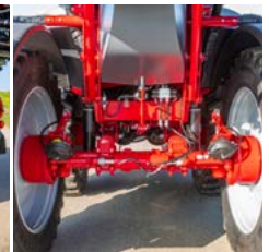
Hydraulisches Fahrwerk und hohe Bodenfreiheit
