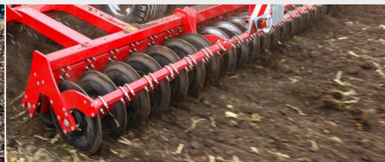
Geschlossener SteelDisc Packer mit schneidenden Packerringen
