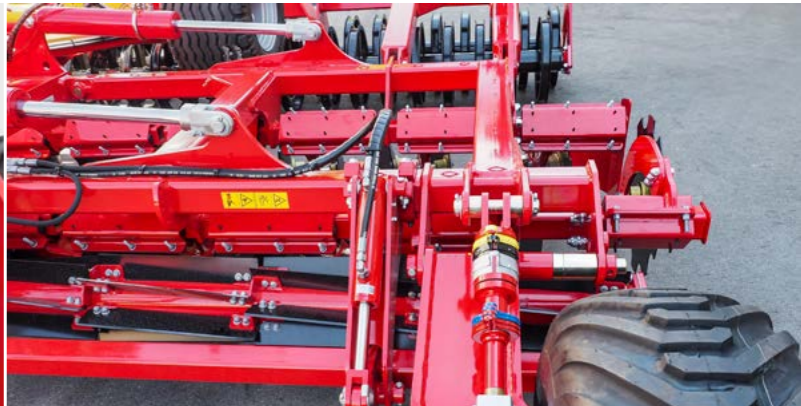
Arbeitstiefenverstellung mit Clips (serienmäßig)
