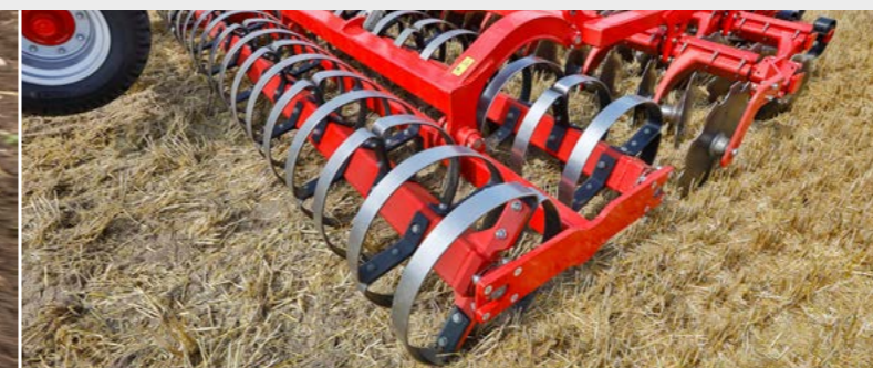
Doppel RingFlex Packer – leichtzügig und hohe Aufstandsfläche
