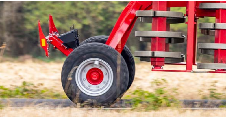
Transportfahrwerk Sicherer Straßentransport, optional Bremsanlage
