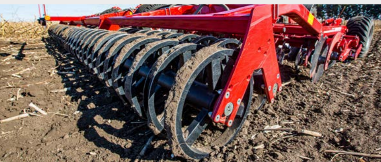
Doppel RollPack Packer für eine gute Krümelung und Rückverfestigung des Bodens
