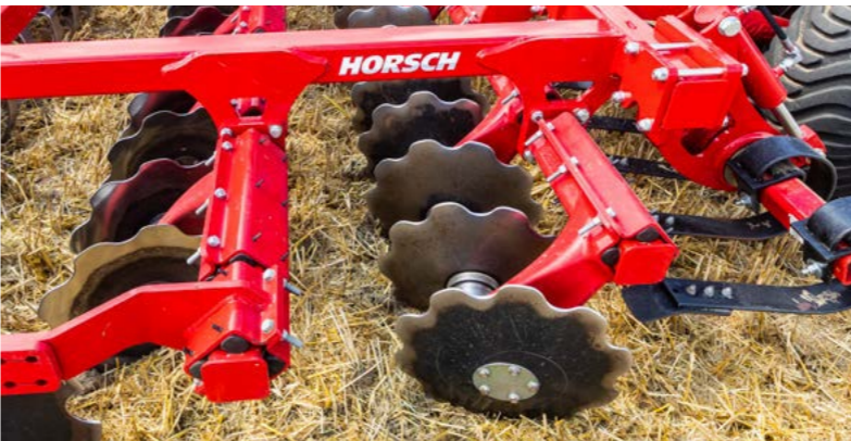
Hoher Durchgang – zwei Scheiben an einem Arm
