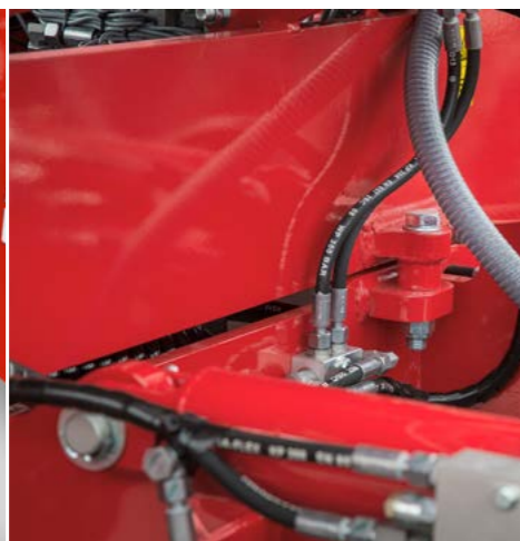
Ankerpunkte für die Umstellung von einem Zinkenfeld auf das Scheibensystem. Einfacher Wechsel durch nur 4 Befestigungspunkte.
