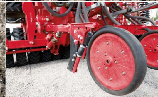
Aussaat von Raps in Reihenabständen 28,6–30, 35 und 50 cm, wahlweise mit TurboDisc oder TurboEdge Schar
