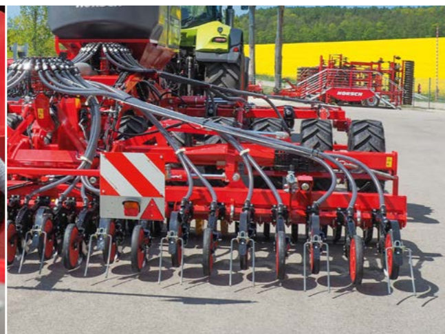
Immer ein TurboDisc Schar folgt mittig einem TerraGrip Zinken und einem Reifen
