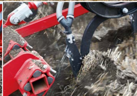
Gezielte Düngung im Reihbereich mit Aufteilung tief, flach oder 50:50
