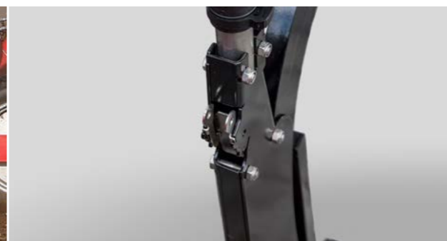
Die Ablage des Düngerdepots erfolgt flach, tief oder 50:50 gemischt
