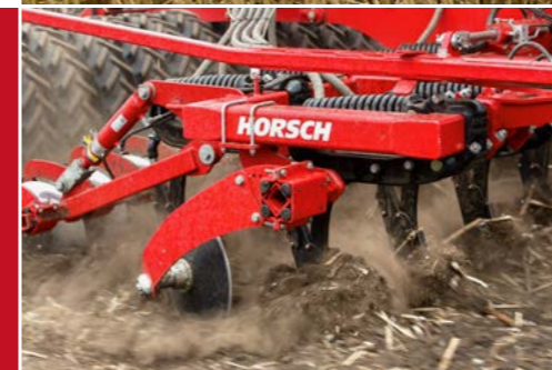
LD Schare bearbeiten den Boden und legen ein exakt platziertes Düngedepot ab.
