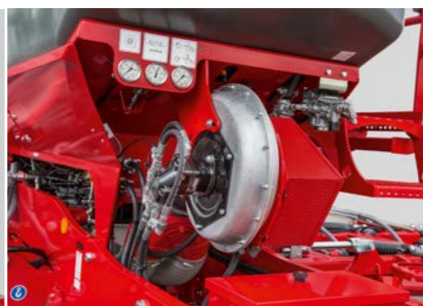
Hydraulisches Gebläse Direktantrieb und aufgeräumte Kabelgarnitur
