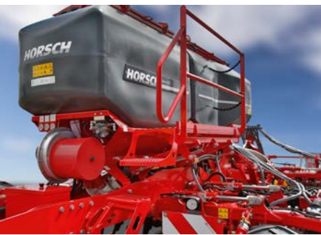
Leiter zum sicheren Erreichen der Tanköffnungen
