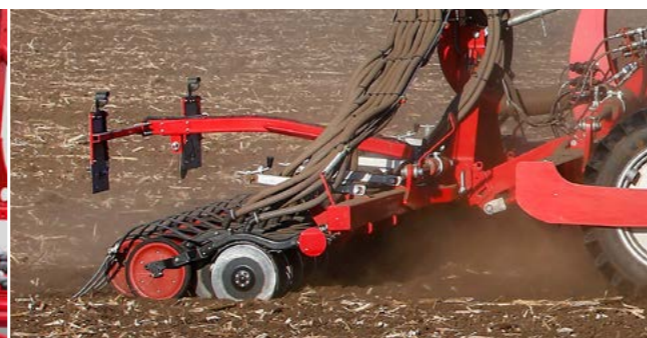
Die überdurchschnittliche Anpassungsfähigkeit (15 cm) des TurboDisc Schares mit integrierter Druckrolle ermöglicht eine präzise und gleichmäßige Tiefenführung. Der hohe Einzelschardruck von bis zu 120 kg sorgt für einen ruhigen Lauf bei Geschwindigkeiten über 12 km/h.
