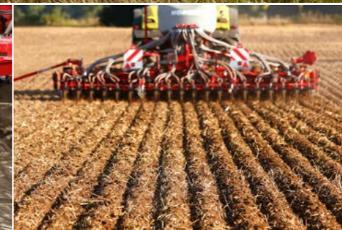
Die TurboDisc Säscharen legen das Saatgut in den kluten- und rückstandsarmen Boden ab.
