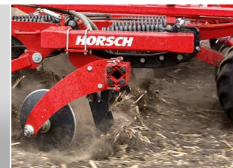
TerraGrip III L Auslösekraft 630 kg
