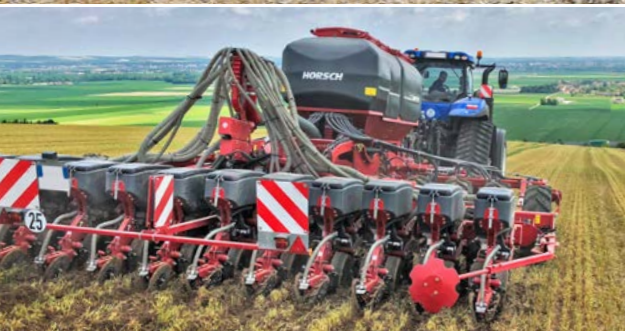
Reihenabstand von 50 cm, Reifenpacker läuft gezielt zwischen den Lockerungsreihen
