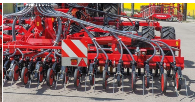
Immer ein TurboDisc Schar folgt mittig einem TerraGrip Zinken und einem Reifen
