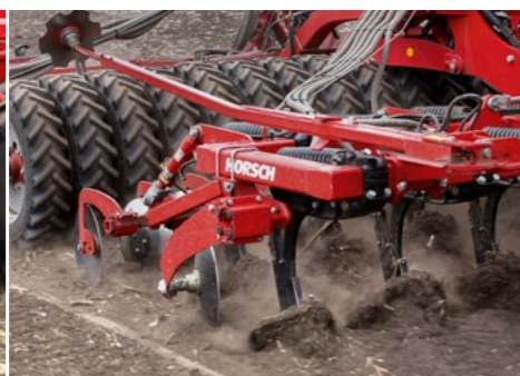
TerraGrip Zinken verlaufen exakt vor den Reifen
