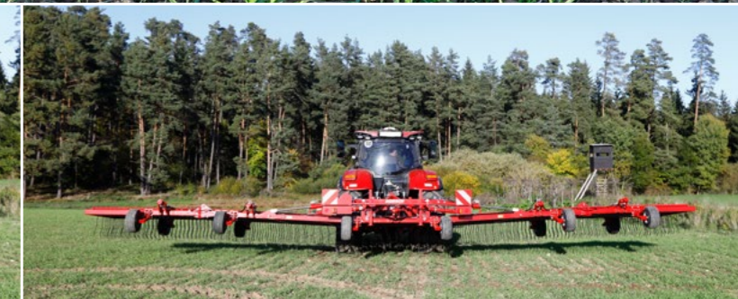
Anwinkelung durch Doppelhubzylinder bei 90° Klappung
