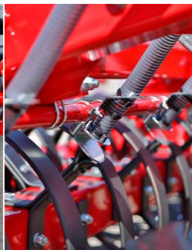
MiniDrill Saatgutverteiler legen das Saatgut direkt im feuchten Boden ab.
