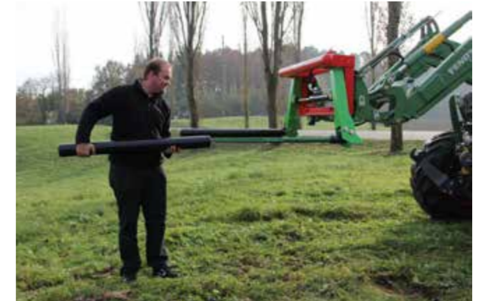
Ballengabel BG 180 – Demontage vom Ballenrohr auf Strohspiess.
