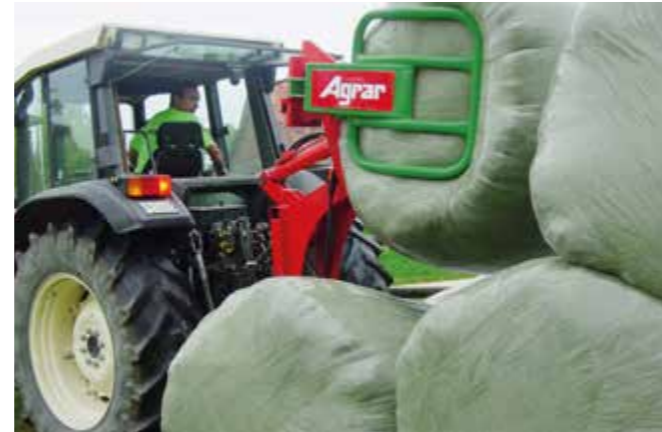
Ballenzange BZ 160 mit Stapelrahmen (Stapelhöhe bis 1.4 m).
