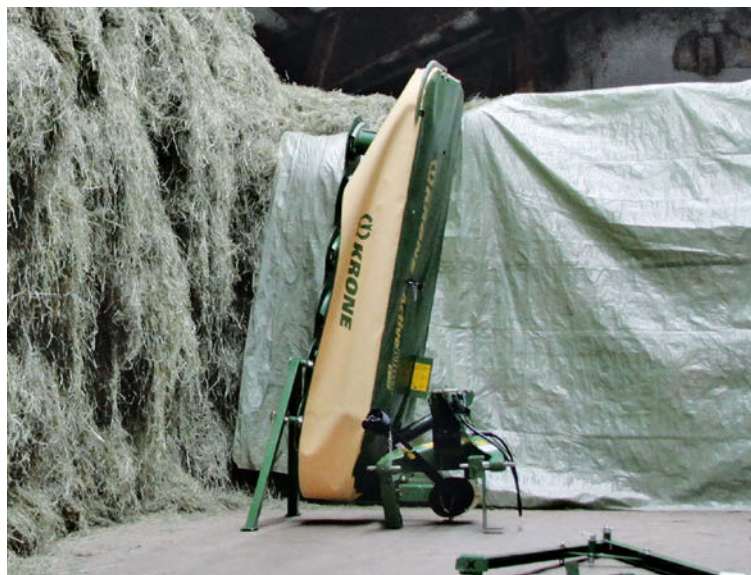
Über den Winter steht das ActiveMow sicher und platzsparend. Die Haltestreben werden in Löchern am Mähbalken mit Bolzen und Splint fixiert.
