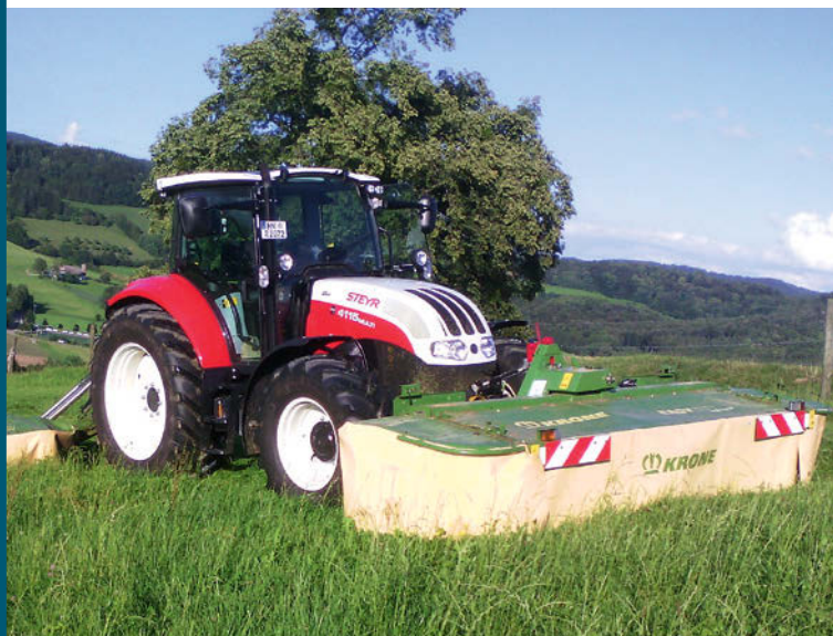
Das Frontmäherwerk arbeitet auch ohne Federpakete in der Front, wenn das Hubwerk, wie hier an einem Steyr Multi, den Auflagedruck regeln kann.
