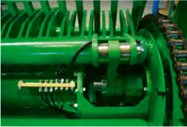
Die 6 lenkergesteuerten Förderschwingen erlauben eine grosse Ladeleistung bei geringem Verschleiss.
