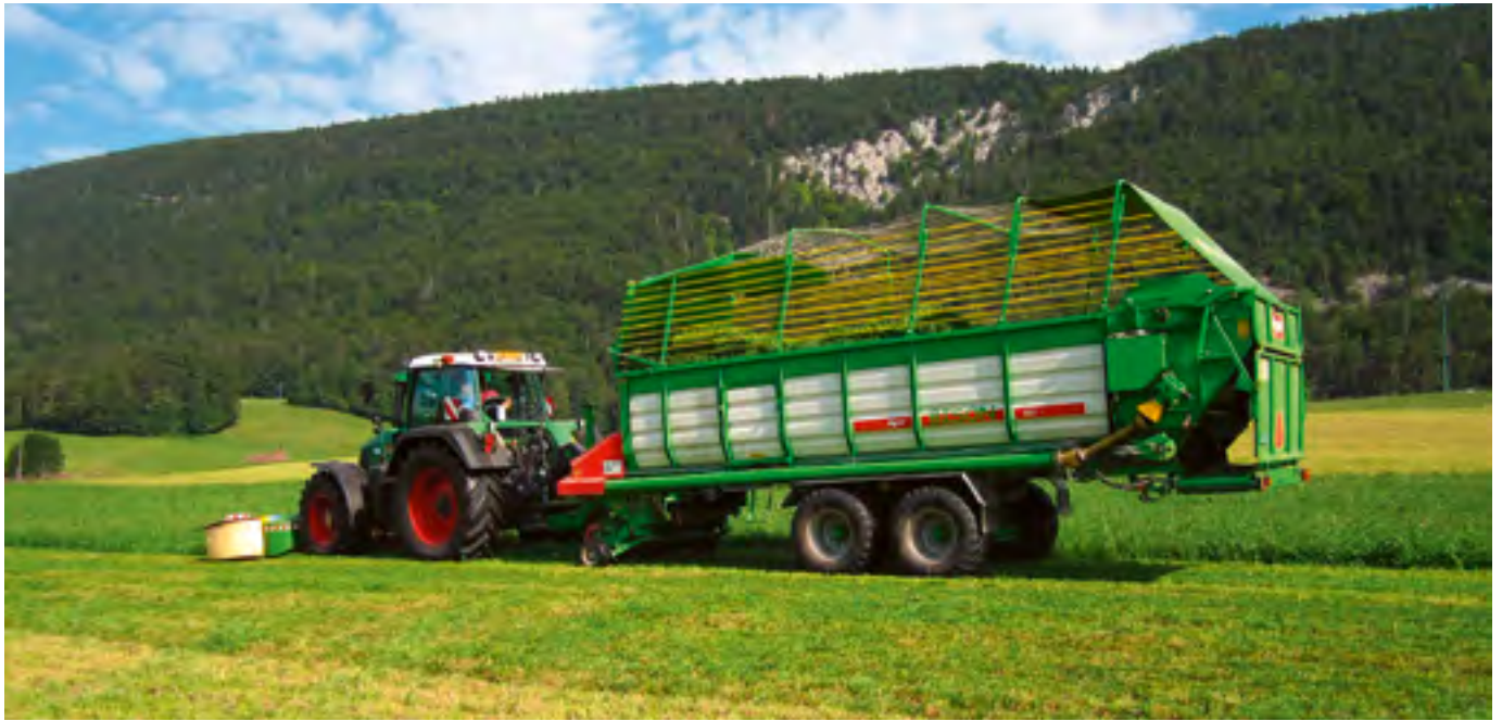
Hohe Intensität: Mit dem Agrar «Bison 552» wird auf dem silofreien Betrieb von Eric Brunnschweiler Heu und Gras für über 100 Stück Vieh eingeführt. Ausgerüstet ist der Ladewagen mit Tandemachse, Dosiereinrichtung und einem Querrörderband. Bilder: zvg
